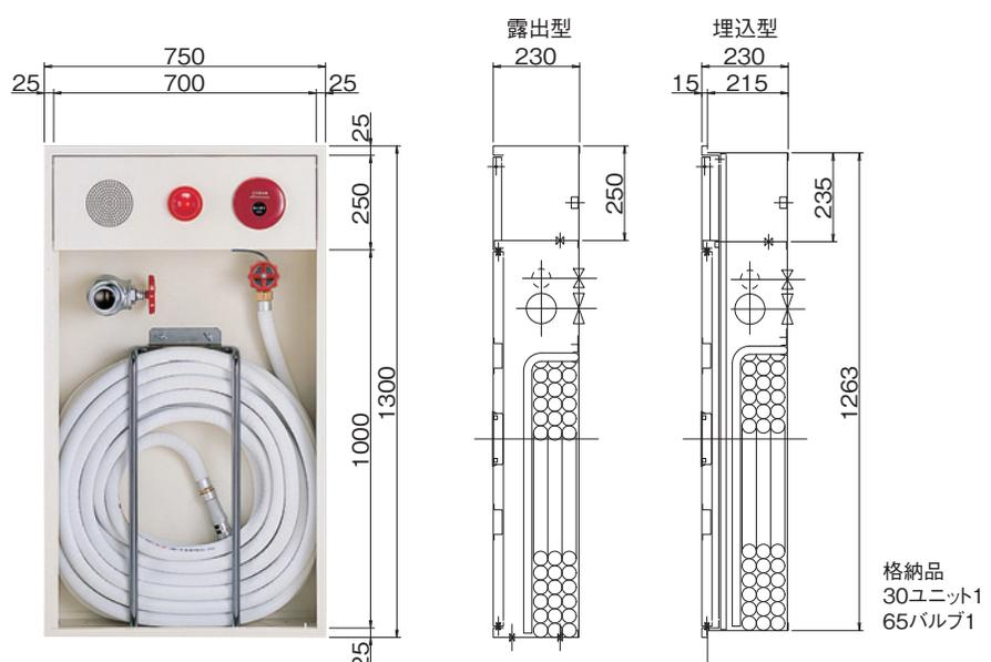
**B674 PR30型二段単独型消火器併設**
