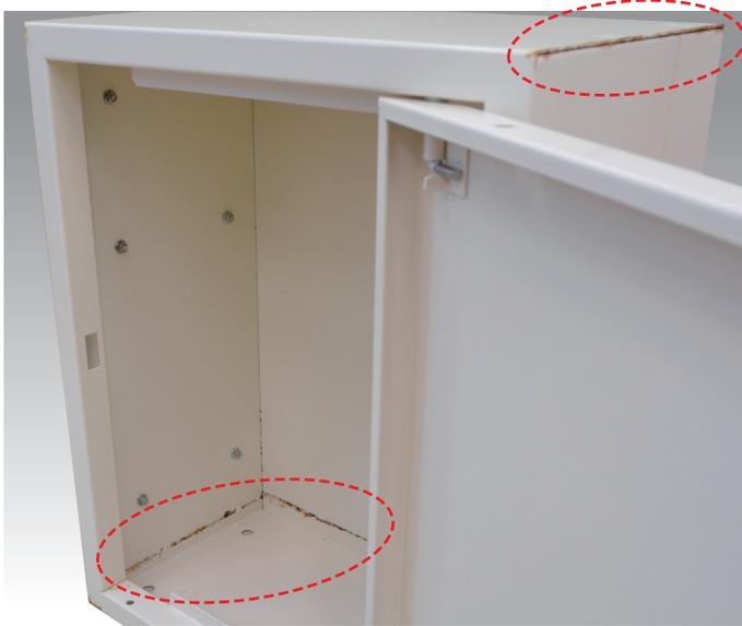
●電気亜鉛めっき鋼板(屋内仕様)では錆びの発生や塗膜の剥がれが確認できます。
