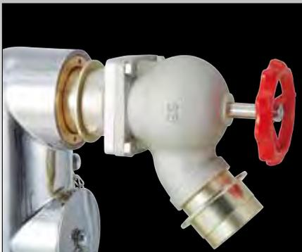
送水口に接続し、大量の排水を可能にします。ハンドルを時計方向に回すと、弁棒が送水口の逆止弁を押し開けます。
